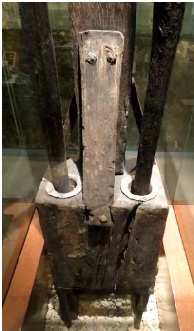
Römische Doppelkolben-Druckpumpen ausgestellt in den Museen in Luxemburg und Metz (Fotos: Oluf Hoyer, mit freundlicher Genehmigung der Museen)
