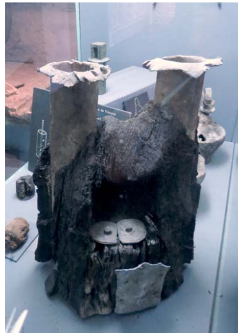
Römische Doppelkolben-Druckpumpen ausgestellt in den Museen in Luxemburg und Metz (Fotos: Oluf Hoyer, mit freundlicher Genehmigung der Museen)
